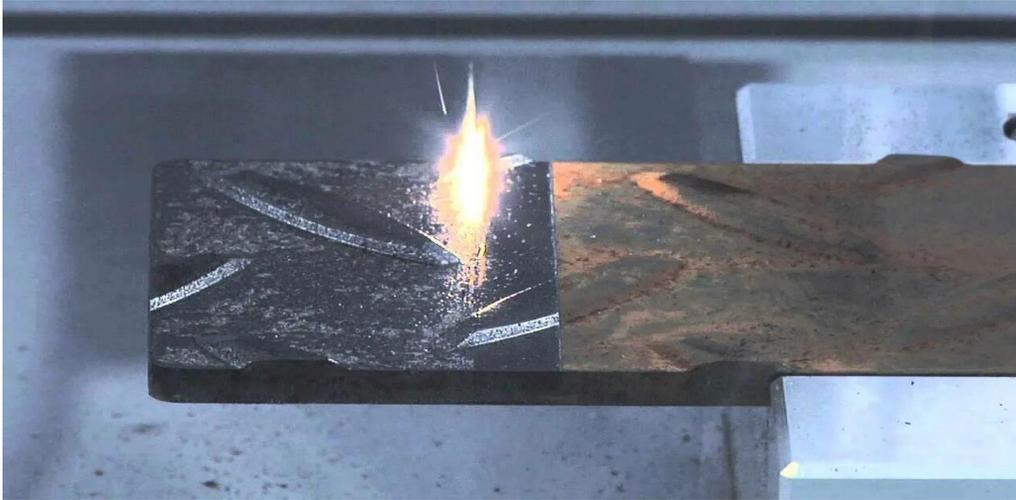
**Лазерная очистка** может быстро и эффективно удалять загрязнения с металлических поверхностей без необходимости в физическом контакте или использовании абразивных материалов.
